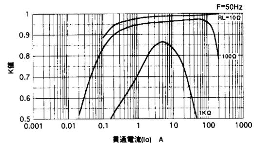
依據使用之用途，利用插值法從特性圖上讀取負載電阻及貫通電流的相對應結合係數 "K" 值，可以計算出輸出電壓的大小。
