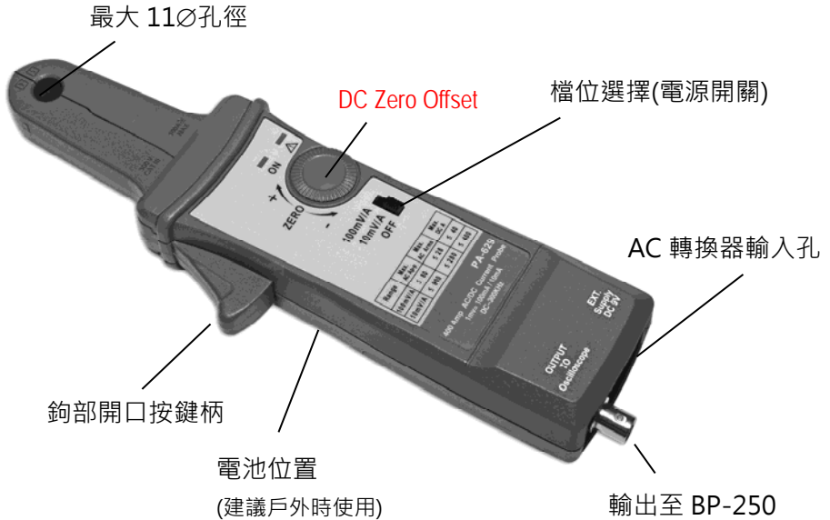
圖 1: PA-659 電流探測鉗上的控制及指示。
