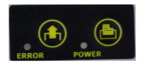
印表機有兩個指示燈用於提示用戶印表機的狀態,兩個指示燈分別為電源 POWER 指示燈和狀態 ERROR 指示燈。
